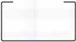
STEEL STUD STUD 63.5 x .55 x 2400mm STUD 63.5 x .55 x 2700mm STUD 63.5 x .55 x 3000mm STUD 63.5 x .55 x 3300mm STUD 63.5 x .75 x 3600mm
